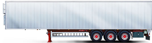
Foto 1: De Knapen Cargo Walk K200: Het 'topmodel' zelfdragende schuifvloeroplegger van Knapen Trailers BV.
